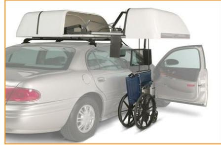
تركيب رافعة مخصصة لمستخدمي الكراسي الكهربائية. هذا النوع من الروافع يتم تشغيله كهربائياً من خارج أو داخل السيارة وهي مصممة للاستخدام في السيارات كبيرة الحجم كالموضحة في الصورة. **ملاحظة: يوجد أنواع عديدة من الروافع وقد أوردنا هنا بعضها للتوضيح لا الحصر.**
