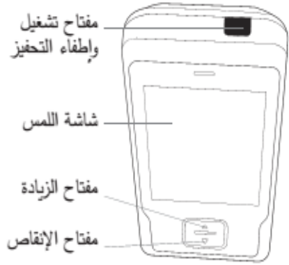
الصورة ١- جهاز التحكم (نموذج رقم ٣٥٣٧)
